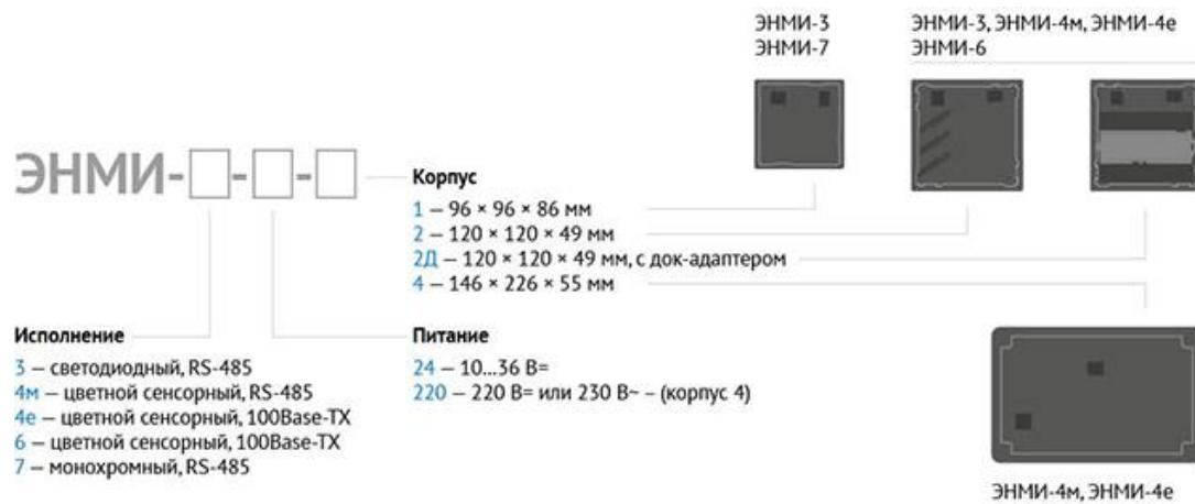
Пример записи обозначения ЭНМИ, которое может быть применено при его заказе и в документации:
