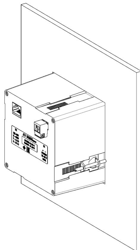
Рисунок 8.6. Модуль индикации ЭНМИ-X-24-1, установленный в щит
