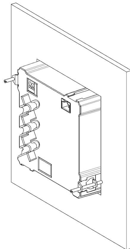
Рисунок 8.2. Модуль индикации ЭНМИ-Х-24-2, установленный в щит
