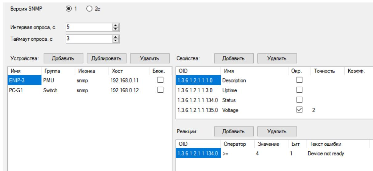
Рисунок 5.9. Настройка опроса устройств для ЭНМИ-6 в ПО «ES Конфигуратор».
