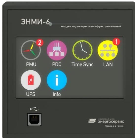
Цветной жидкокристаллический (TFT) индикатор ЭНМИ-6 позволяет отображать диагностические параметры опрашиваемых устройств, включать обобщенный сигнал неисправности (при возникновении ошибок), используя встроенный дискретный выход, а также передавать по протоколу Modbus TCP состояние диагностируемых устройств.
