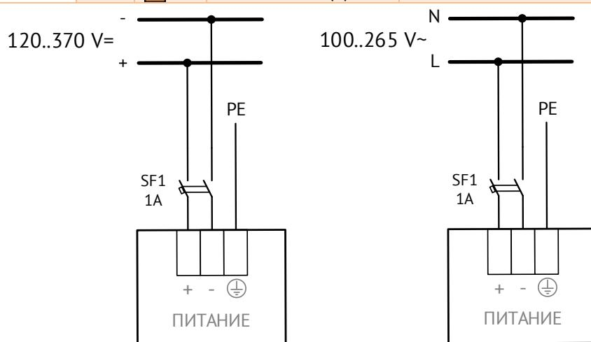
Рисунок 8.11. Схема подключения питания ЭНМИ-4м/4е-220-4 для постоянного (слева) и переменного (справа) напряжения
