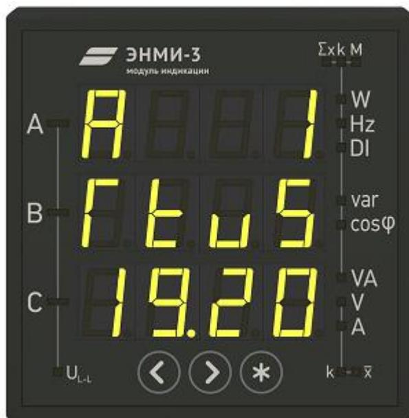
Рисунок 3.1 Параметры последовательного интерфейса
