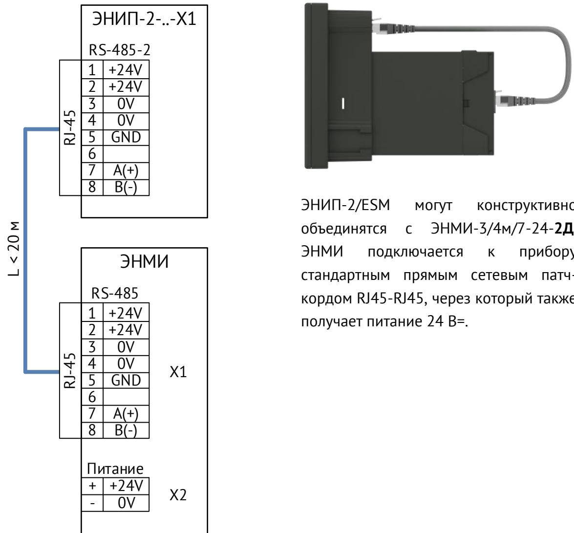
Рисунок 8.10. Схема подключения модуля индикации ЭНМИ к преобразователю ЭНИП-2/ESM
