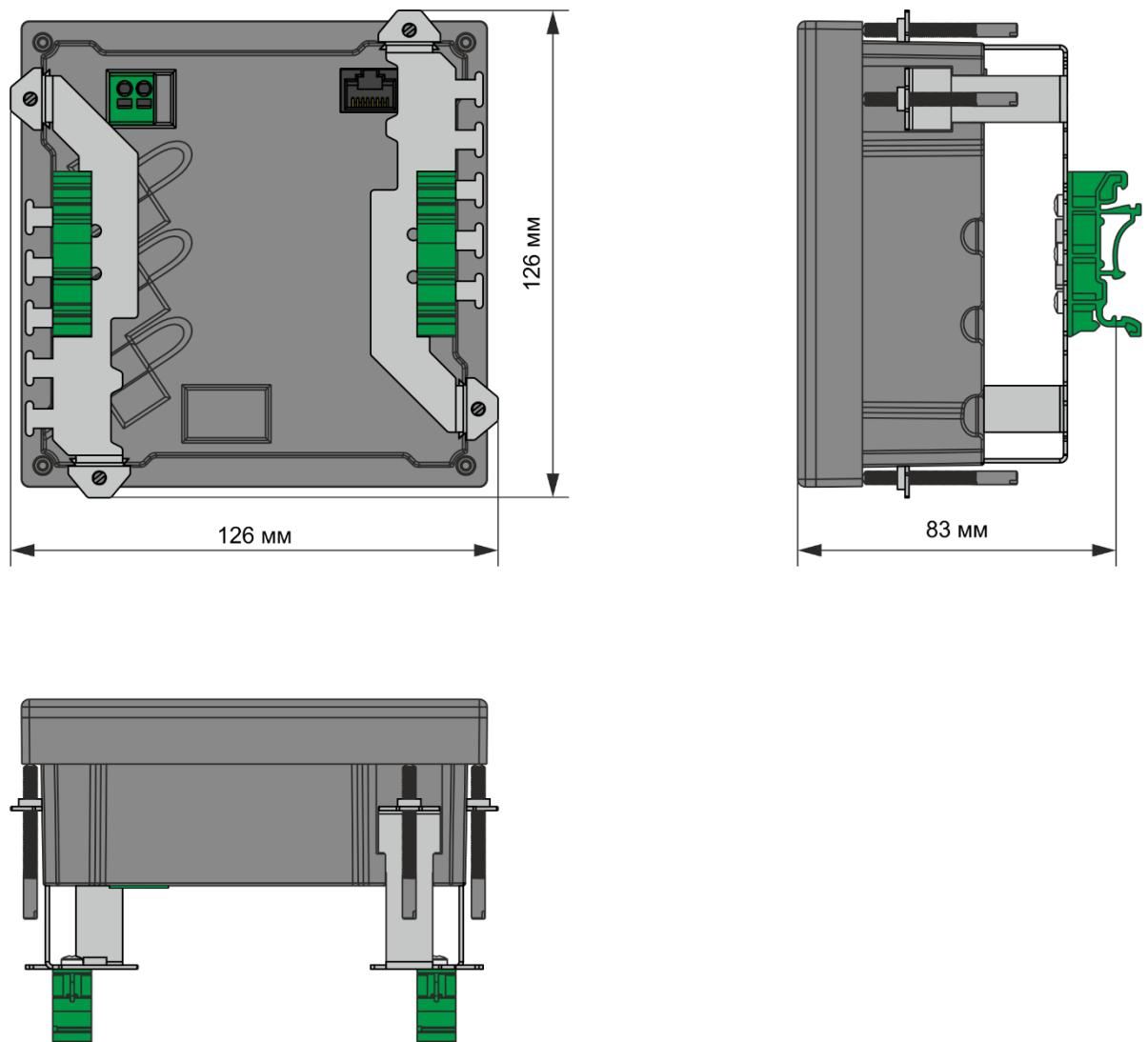
Рисунок 1.5. Габаритные размеры ЭНМИ-X-24-2 с кронштейном PDIN-KP (опция) для крепления на DIN-рейку
