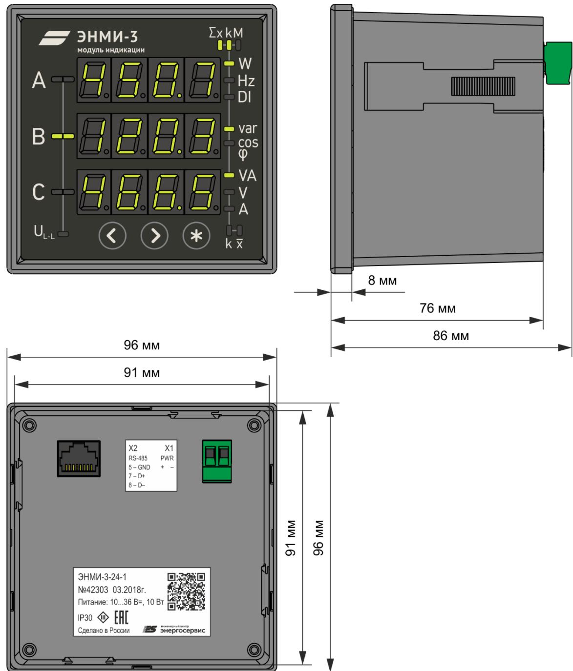
Рисунок 1.3. Габаритные размеры модификации ЭНМИ-X-24-1
