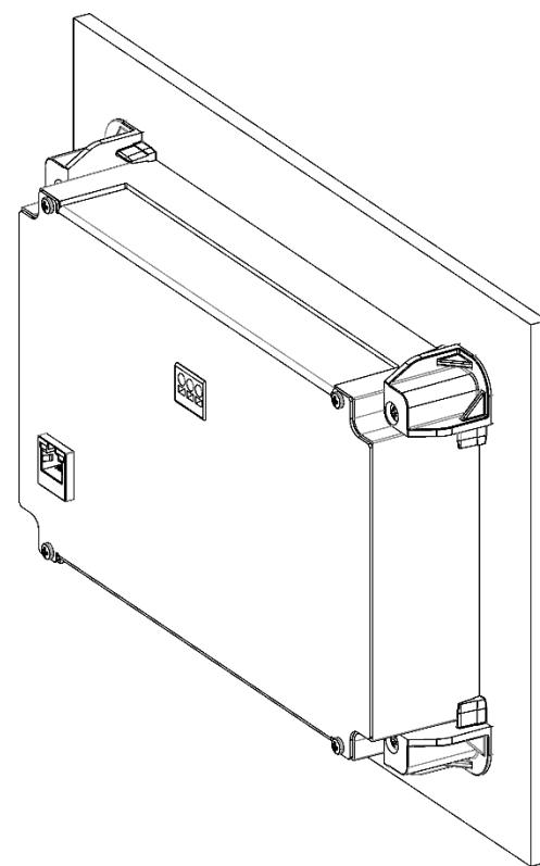
Рисунок 8.8. Модуль индикации ЭНМИ-Х-Х-4, установленный в щит
