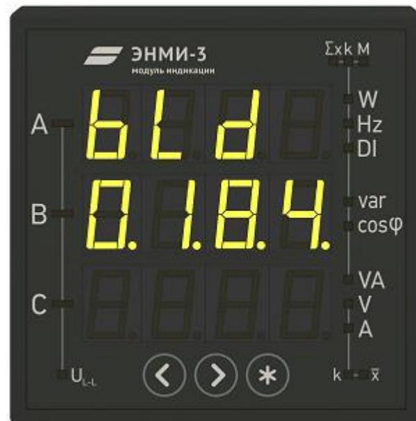
Рисунок 3.6 Версия прошивки ЭНМИ-3
