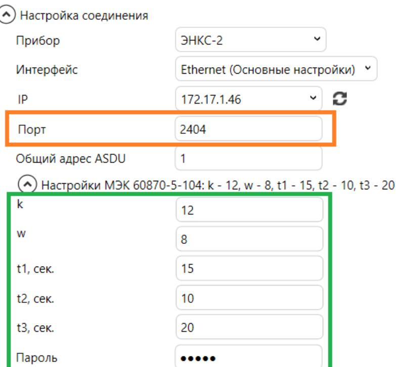
Рисунок 7.8. Настройки параметров подключения к УСД: оранжевые – должны совпадать с параметрами УСД в разделе Каналы; зеленые – должны соответствовать настройкам МЭК 104 в разделе Сеть
