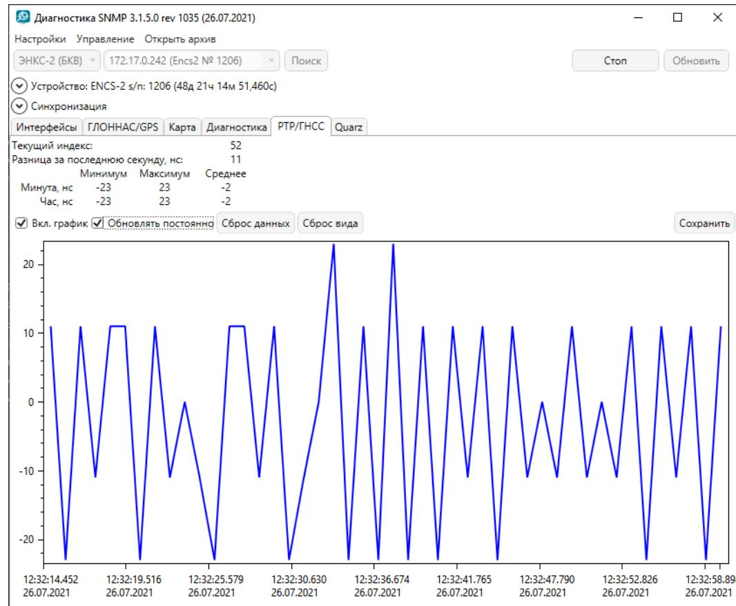
Рисунок 3.1. Статистика разницы часов между РТР и ГЛОНАСС/GPS
