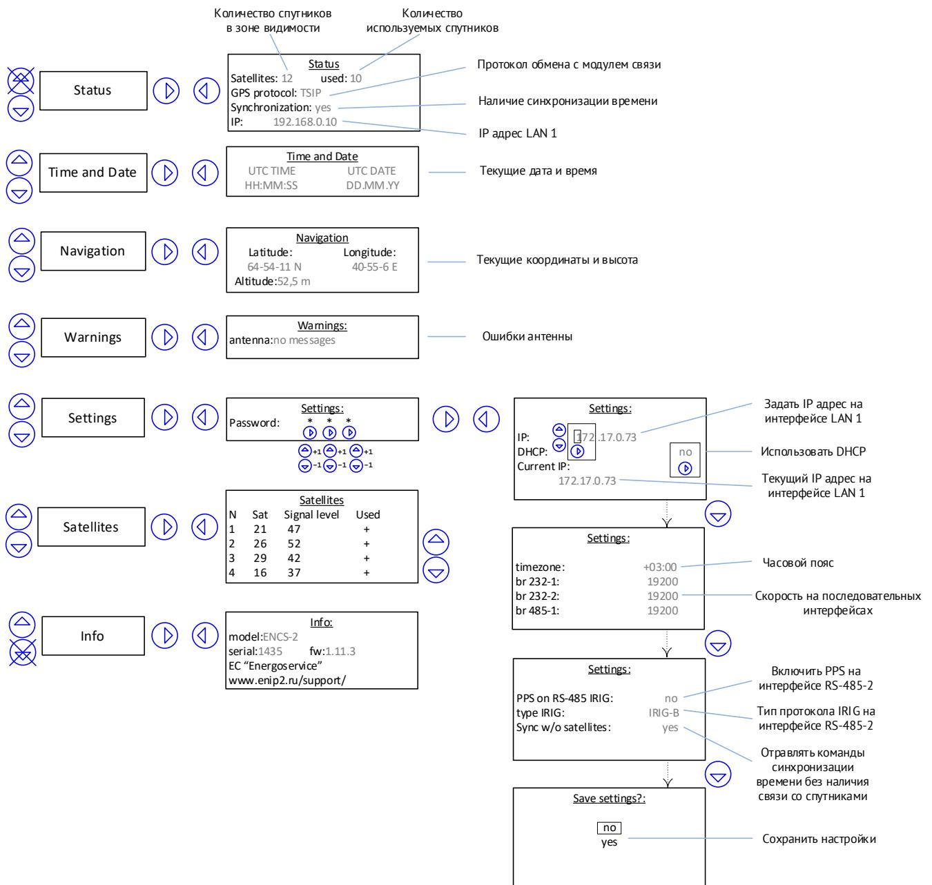
Рисунок 7.5. Структурная схема меню БКВ ЭНКС-2, выводимом на встроенном дисплее
