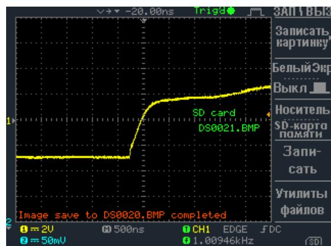
Рисунок 6.4. Линия, согласованная 120 Ом. Видео: [enip2.ru/files/rs485\\_04.zip](http://enip2.ru/files/rs485_04.zip)
