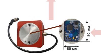
Цифровой КДТН **TECV.P1-10** со **встроенным** преобразователем аналоговых сигналов (AMU) на базе серийного ENMU
