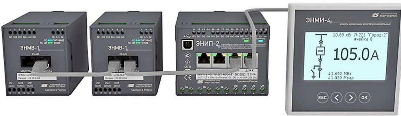
**Рис. 1.** Интеллектуальное электронное устройство ЭНИП-2 с модулями расширения
