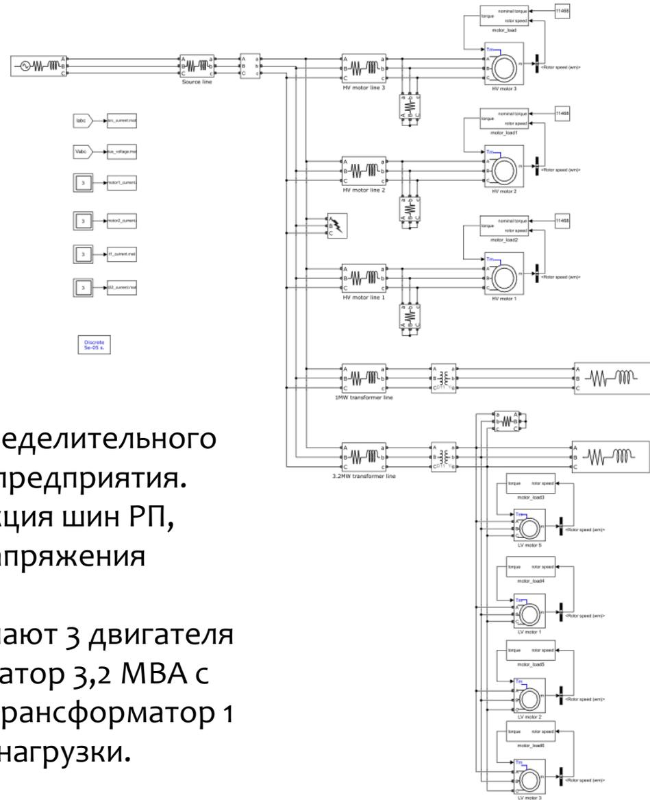
Защита питающей линии и шин для распределительного устройства 6 кВ целлюлозно-бумажного предприятия.
