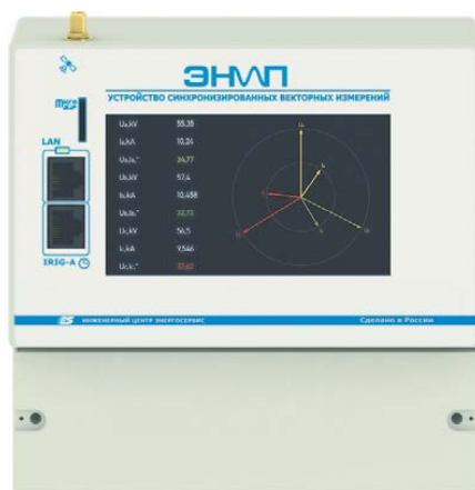
Рис. 2. Интеллектуальное электронное устройство ЭНИП-3.
