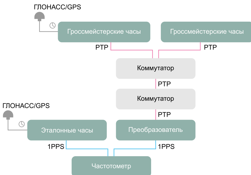
Рис. 4. Схема проверки локальной сети с поддержкой PTPv2
