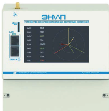
Рис. 2. Интеллектуальное электронное устройство ЭНИП-3.
