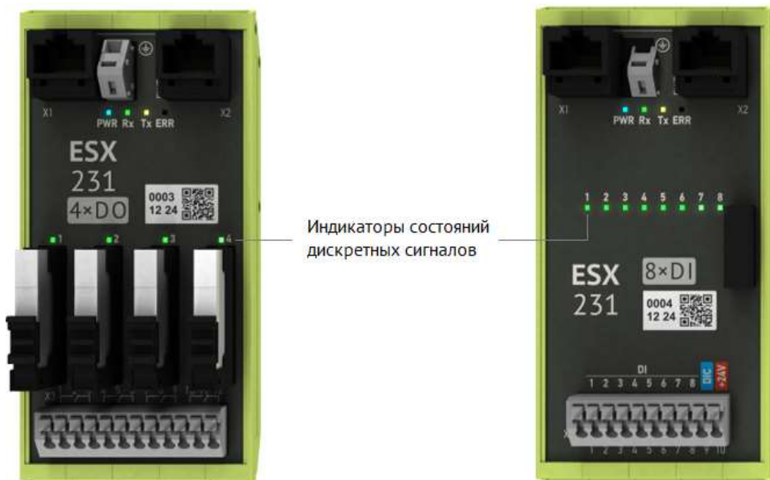
Рисунок 3.2. Индикаторы состояний дискретных сигналов
