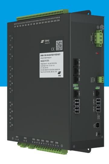
ENMU предназначен для преобразования аналоговых сигналов, ввода и вывода дискретных сигналов. Дополнительно ENMU выполняет функции устройства синхронизированных векторных измерений, а также регистратора аварийных событий.
