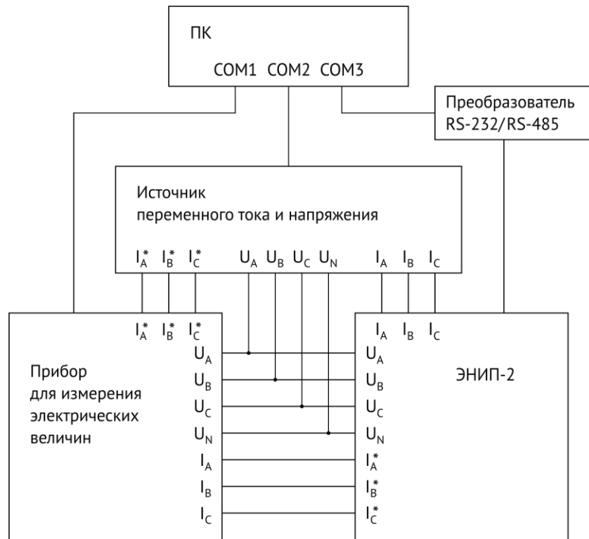
Рисунок 3 – Схема рабочего места при проверке преобразователей ЭНИП-2
