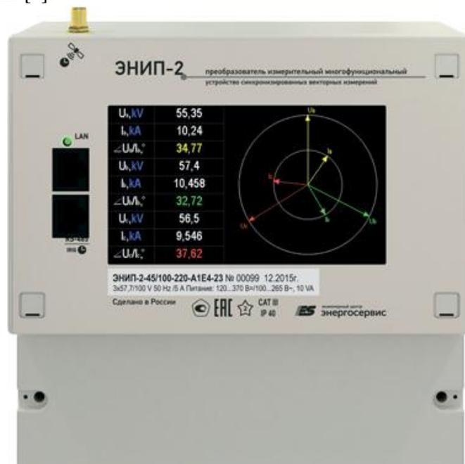
Рис. 1: Устройство синхронизированных векторных измерений ЭНИП-2-УСВИ
