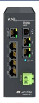
AMU (Analog Merging Unit). Аналоговое устройство сопряжения с комбинированными первичными датчиками тока и напряжения: трансформаторы тока малой мощности со встроенным шунтом и с низкоуровневыми выходными напряжениями (Low Power Current Transformer, LPCT), датчики тока на основе катушки Роговского, емкостные или резистивные датчики напряжения, комбинированные датчики тока и напряжения.
