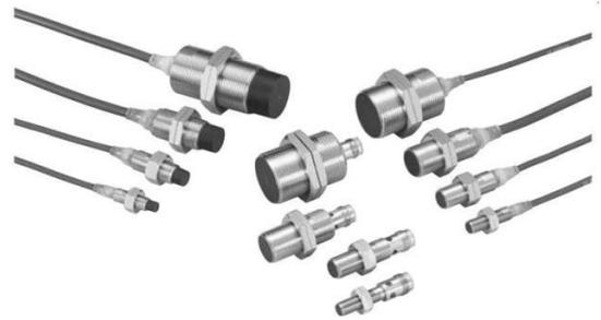
**Целесообразность применения бесконтактных датчиков положения** вместо концевых выключателей обусловлена следующими преимуществами: отсутствие “дребезга” контактов, отсутствие необходимости пробоя оксидной пленки, сокращение количества контрольных проводов, уменьшение потребления оперативного тока, повышение надежности и возможность диагностики подсистемы ввода-вывода дискретной информации
