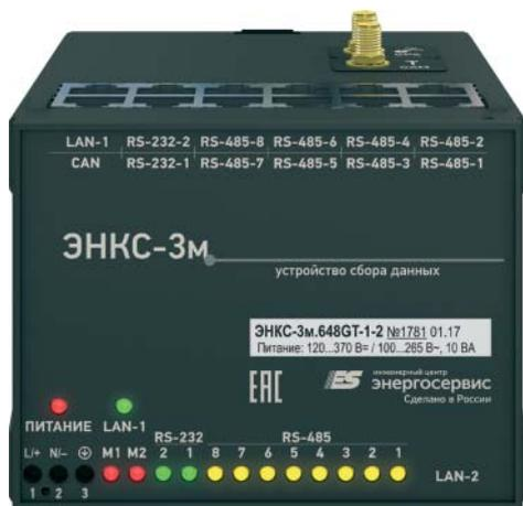
Рис. 3. Устройство сбора данных ЭНКС-3м
