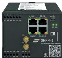
ЭНКМ-3 – устройство сбора данных со встроенными дискретными и аналоговыми входами и дискретными выходами. Осуществляет опрос до 64 устройств и ретрансляцию данных по 14 независимо настраиваемым каналам.
