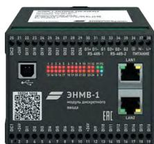
Модули ввода-вывода ЭНМВ-1 с дискретными или аналоговыми входами и дискретными выходами. Доступны на выбор различные наборы портов RS-485 и Ethernet. Поддержка МЭК 61850-8-1, МЭК 60870-5-101/104, Modbus RTU/TCP.
