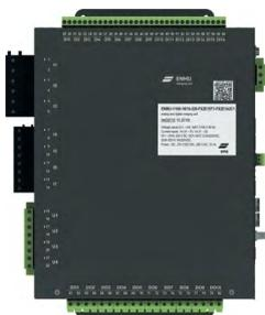
Преобразователи аналоговых и дискретных сигналов ENMU применяются на цифровых подстанциях для аналого-цифрового преобразования сигналов трансформаторов тока и напряжения и сопряжения дискретных сигналов с шиной процесса и шиной станции. IEC 61850-9-2 (4 потока), IEC 61850-8-1 (MMS, GOOSE), МЭК 60870-5-104, С37.118.2 (УСВИ/PMU). Регистрация аварийных событий (FTP). Синхронизация времени в соответствии с IEEE 1588v2 PTP.
