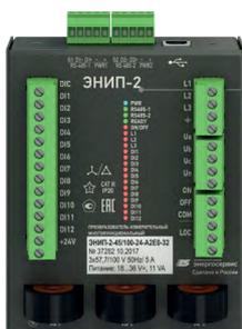
Измерение параметров режима электрической сети, технический учет электроэнергии. Оптимизирован для применения в ячейках КРУ 6-20 кВ. На борту 12 дискретных входов 24 В= и 3 дискретных выхода 250 В~/= 6 А. Подключение до 10 внешних модулей ввода-вывода.
