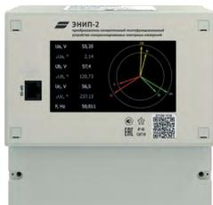
Цифровое УСВИ ЭНИП-2 принимает сигналы тока и напряжения в соответствии с IEC 61850-9-2LE. Интерфейсы: 1 × RS-485, 2 × 100Base-TX. Синхронизация часов осуществляется от БКВ ЭНКС-2. Имеет 5 дискретных входов 24 В=, 3 дискретных выхода.
