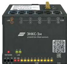
ЭНКС-3м – устройство сбора данных для электростанций и подстанций. Осуществляет опрос до 240 устройств и ретрансляцию данных по 16 независимо настраиваемым каналам.
